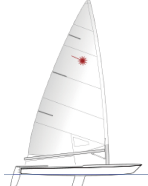
レーザー級 全長: 4.23m / 幅: 1.37m 重量: 58kg セーリング面積: 7.06㎡ アトランタオリンピックから正式種目(当時は男子のみ)
