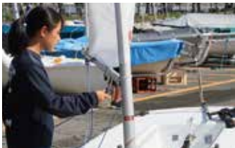
レーザー級 全長: 4.23m / 幅: 1.37m 重量: 58kg セーリング面積: 7.06㎡ アトランタオリンピックから正式種目(当時は男子のみ)
